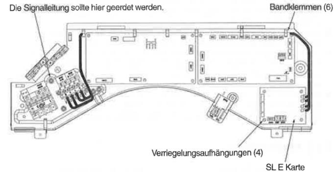
Stromschlaggefahr! Stellen Sie sicher, dass bei Wartungsarbeiten der Strom ausgeschaltet ist. Gehen Sie vorsichtig vor, um keine übermäßige Kraft auf die Verkabelung auszuüben. Lassen Sie die SL E-Karte nicht an der Verkabelung hängen. Beschädigen Sie die Karte nicht mit einem Schraubenzieher.
