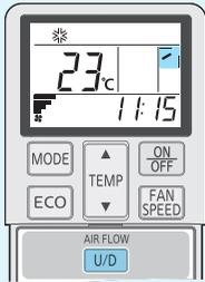
Das Display zeigt die eingestellte vertikale **Luftrichtung**.
