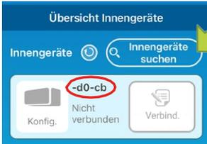
Sicherstellen, dass die letzten 6 Ziffern der SSID, die auf dem WLAN-Adapter angegeben ist, als Name des Innengeräts angezeigt werden (siehe auch „10.1.18.8 Etikett mit SSID, Key und MAC-Adresse des WLAN-Adapters aufbewahren“ auf Seite 165).
