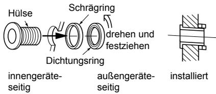
4. Nach Fertigstellung der Leitungsarbeiten die Bohrung in der Wand vollständig mit Dichtungskitt verschließen.
