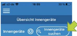
1. Sicherstellen, dass in der Smart M-Air-App die Seite **Übersicht Innengeräte** angezeigt wird. Falls die Schaltfläche **Innengeräte suchen** nicht angezeigt wird, sicherstellen, dass eine WLAN-Verbindung auf dem mobilen Endgerät besteht (siehe Schritt 1 in „10.1.18.4 Benutzerzugang in der Smart M-Air-App anlegen“ auf Seite 155).
