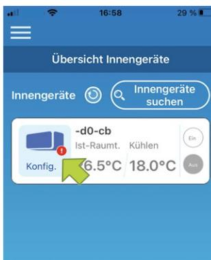
Abbildung 83: Übersicht Innengeräte mit Symbol neben dem Innengerät
