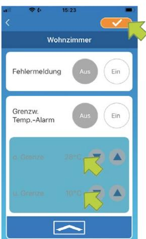
Abbildung 68: Grenzwerte für den Temperaturalarm
