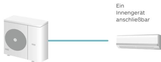
Ein Innengerät anschließbar
